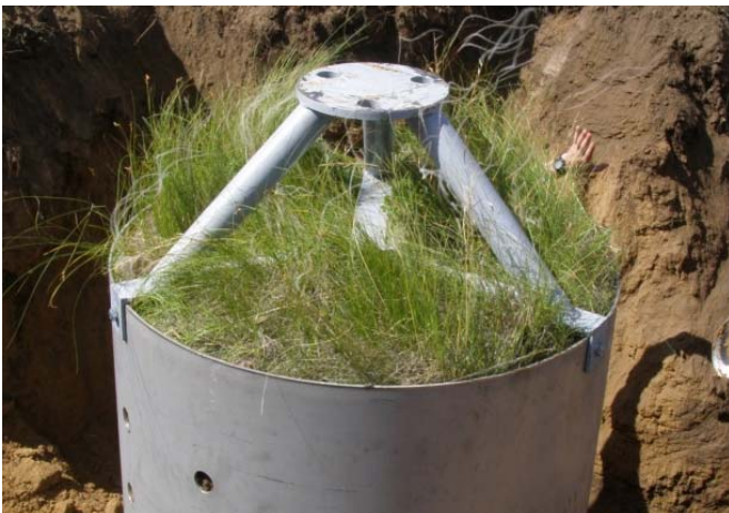
Извлеченный ненарушенный монолит
